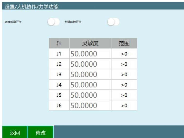
**碰撞检测开关：**开启后机器人会根据灵敏度对碰撞进行检测，通常需要多试几次找到机器人运行时不会自己判定已发生碰撞的值，然后就可以正常使用；
