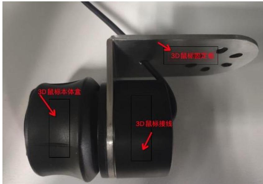
其中 3D 鼠标置线盒用于收纳部分 3D 鼠标连接线缆，固定板用于将 3D 鼠标安装在机器人末端。将 3D 鼠标的组件按上图所示拼接完成后即可安装于机器人末端。同时，3D 鼠标也可以不安装在机器人末端使用，但此时拖动起来的方向感不如装于机器人末端直观。
