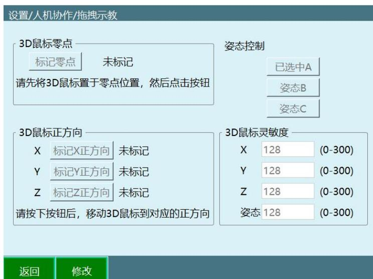
**若把 3D 鼠标安装在机器人本体上，使用前一定要确认机器**
