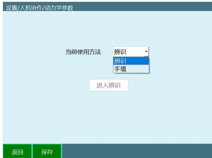
在选择辨识后会进入辨识界面，中间需要仔细阅读辨识的相关注意事项。机器人进行辨识时最好是范围和速度由小到大，如果有外界因素导致机器人无法到达 100 的轨迹范围，可以适当的调小关节参数中的正反限位，在进行测试运行后确定机器人周围没有障碍可以以 100 的速度运行就可以开始辨识，辨识过程中最好不要动示教盒并远离机器人，除非要暂停，可以通过切换模式、点击示教盒上的停止、按下急停按钮来停止机器人。
